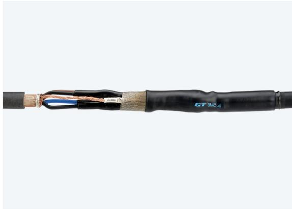
Anwendung Im Freien und im Erdreich, im Wasser und in Kabelschächten, in Innenräumen Zum Verbinden von Steuer- und Signalkabel mit konzentrischem Leiter mit Isolierungen aus PVC, PE und VPE Geeignet für Pressverbinder für Aluminium und Kupferkabel
