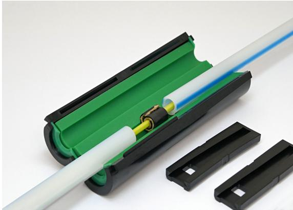
Der teilbare Rohr-Reparaturatz + Gas-Stop eignet sich, um eine gas- und wasserdichte Abdichtung bei einem beschädigten Schutzrohr (Subduct) herzustellen, wenn dieses Rohr bereits mit einem Kabel belegt ist.
